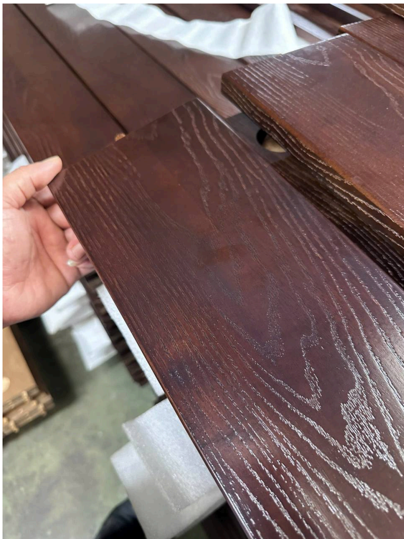
Ảnh 1 — Mặt sơn bị ố trên tấm sơn màu nâu đỏ sẫm (bán bóng), vết ố nằm dọc rãnh thớ — Bùi Thiên Lộc cung cấp 18/09/2026
