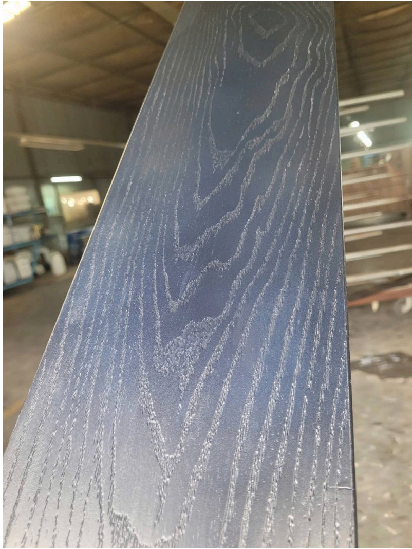
Ảnh 2 — Mặt sơn bị ố trên tấm mặt chải thớ, màu xám đen, vết ố nằm trong rãnh thớ — Bùi Thiên Lộc cung cấp 18/09/2026
