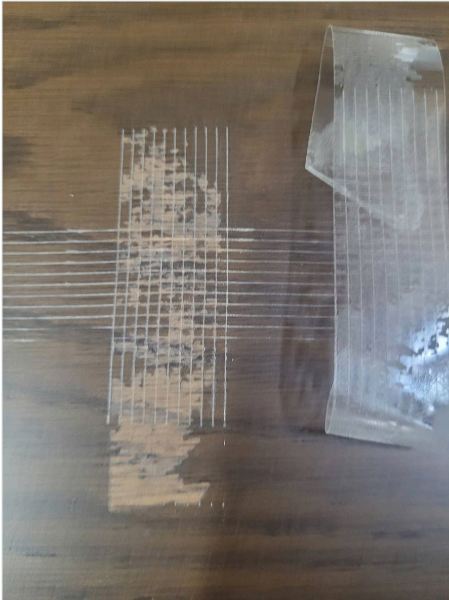
Hình 6 — Ảnh minh họa hiện tượng bong tróc màng sơn khi test cắt carô giặt bằng keo (ảnh trong hồ sơ kiểm tra của Phòng QC; hồ sơ chưa có ảnh cận cảnh vết tróc riêng của lô Đăng Long)
