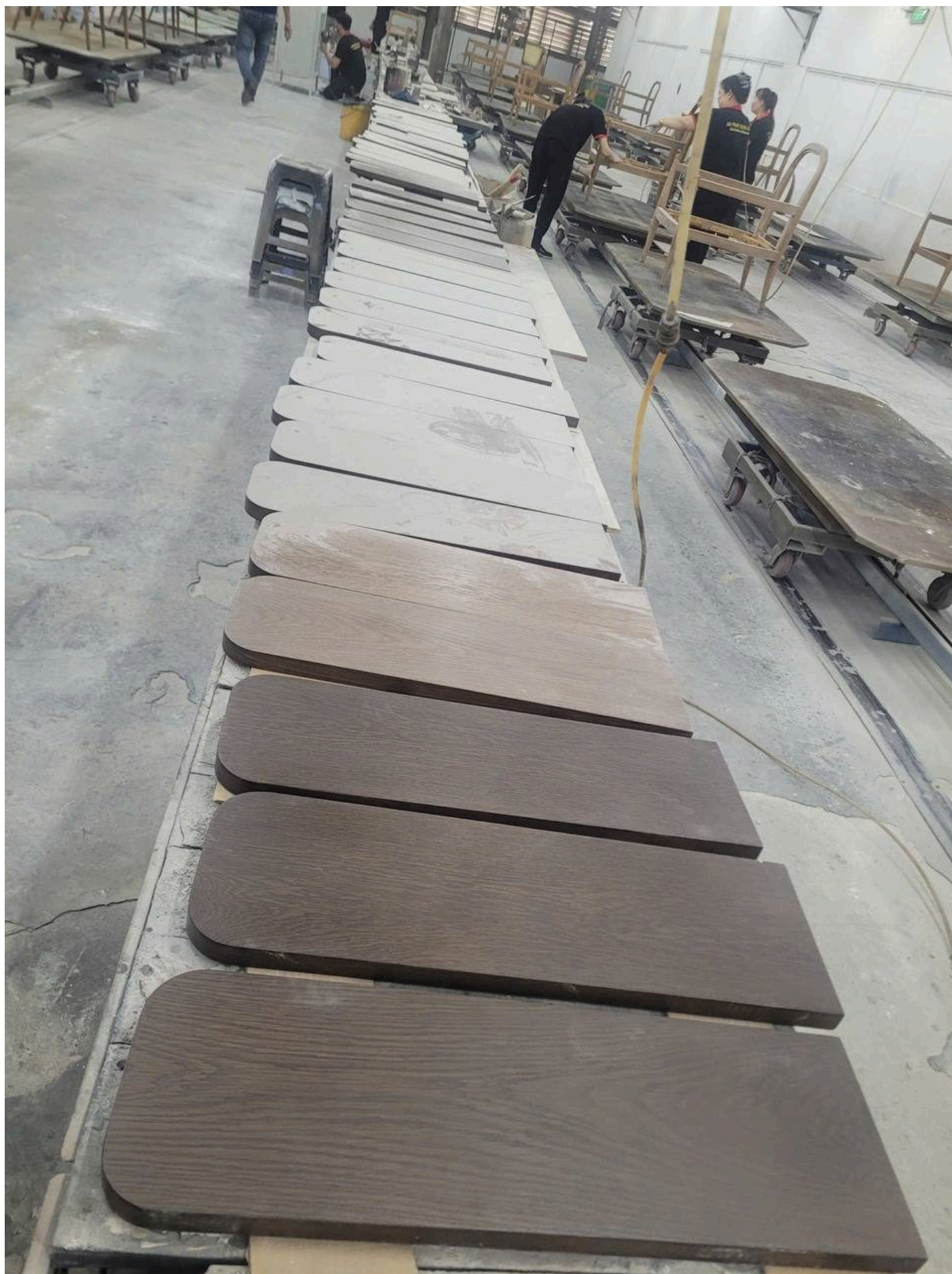
Bối cảnh chuyền sản xuất tại An Phát Cường: dãy sản phẩm màu sẫm đã hoàn thiện 1 mặt, phía xa là các tấm chưa sơn/phủ bụi đang chờ sang công đoạn — khu vực kiểm tra độ bám (ảnh người dùng cung cấp, 11/09/2026).
