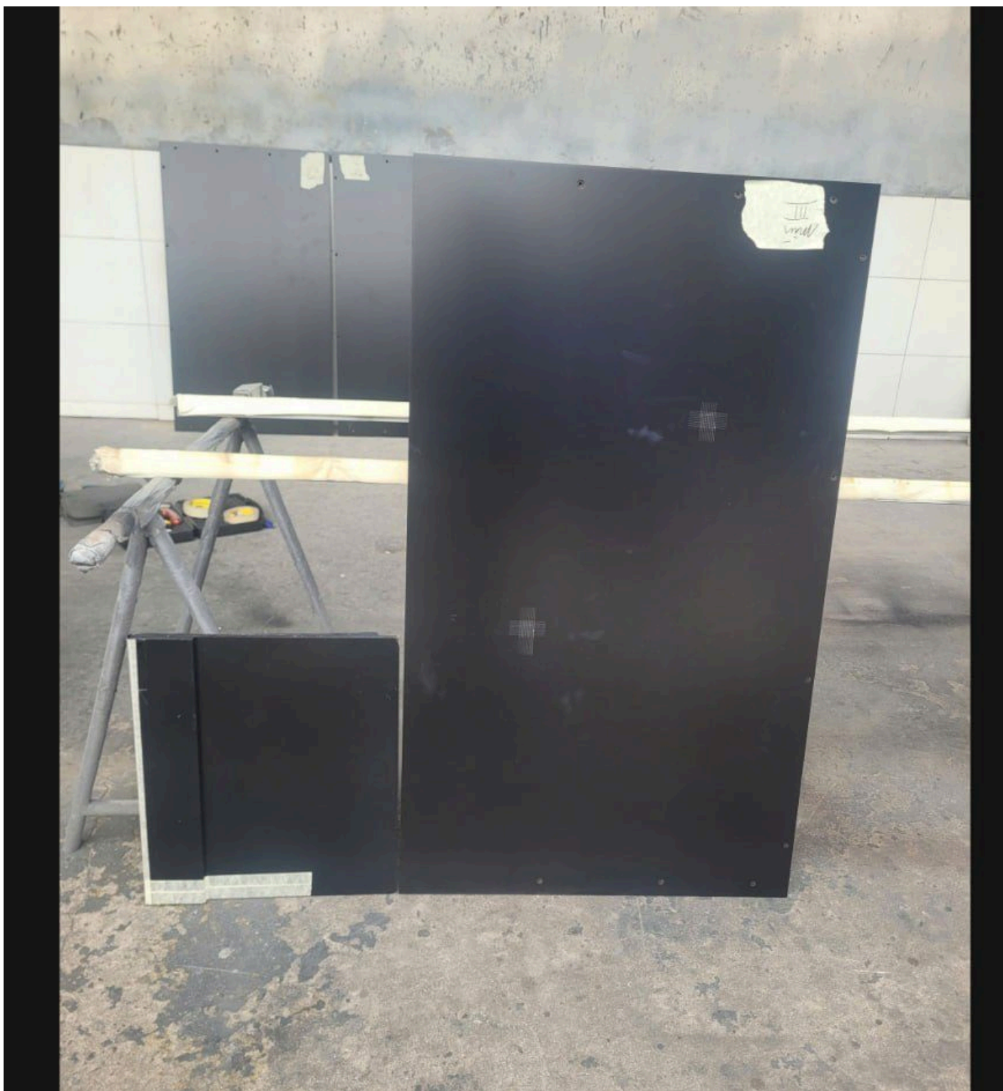
Hình: chi tiết đầu giường mẫu III (nhãn dán "III") — bề mặt lót màu NC KH 3900 có 2 vị trí cắt caro kiểm tra độ bám dính, kết quả đạt (ảnh người dùng cung cấp, 12/08/2026).
