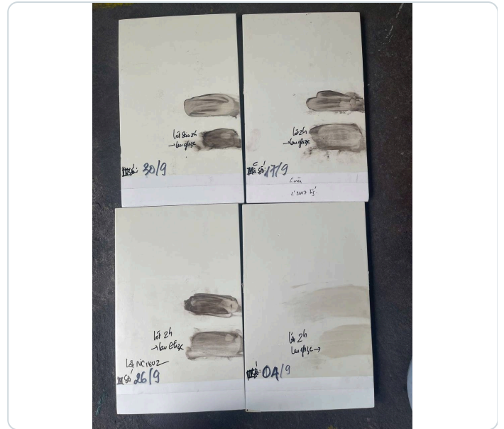
Thẻ mẫu 4 lô Lót NC 1807 sau khi lau glaze màu: lô 04/09 đạt, 3 lô 17/09 · 26/09 · 30/09 màng sơn bị rút — không đạt (05/10/2026).
