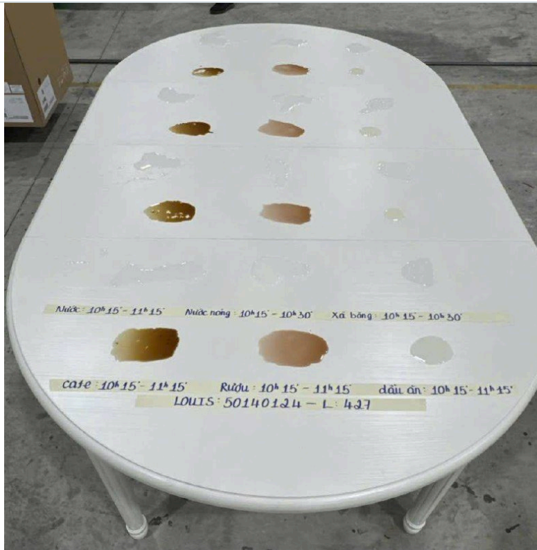
Mặt bàn LOUIS thử chỉ tiêu kháng hoá chất (dải băng keo ghi tên chất + mốc giờ) tại Mê Kông III — 08/10/2026.
