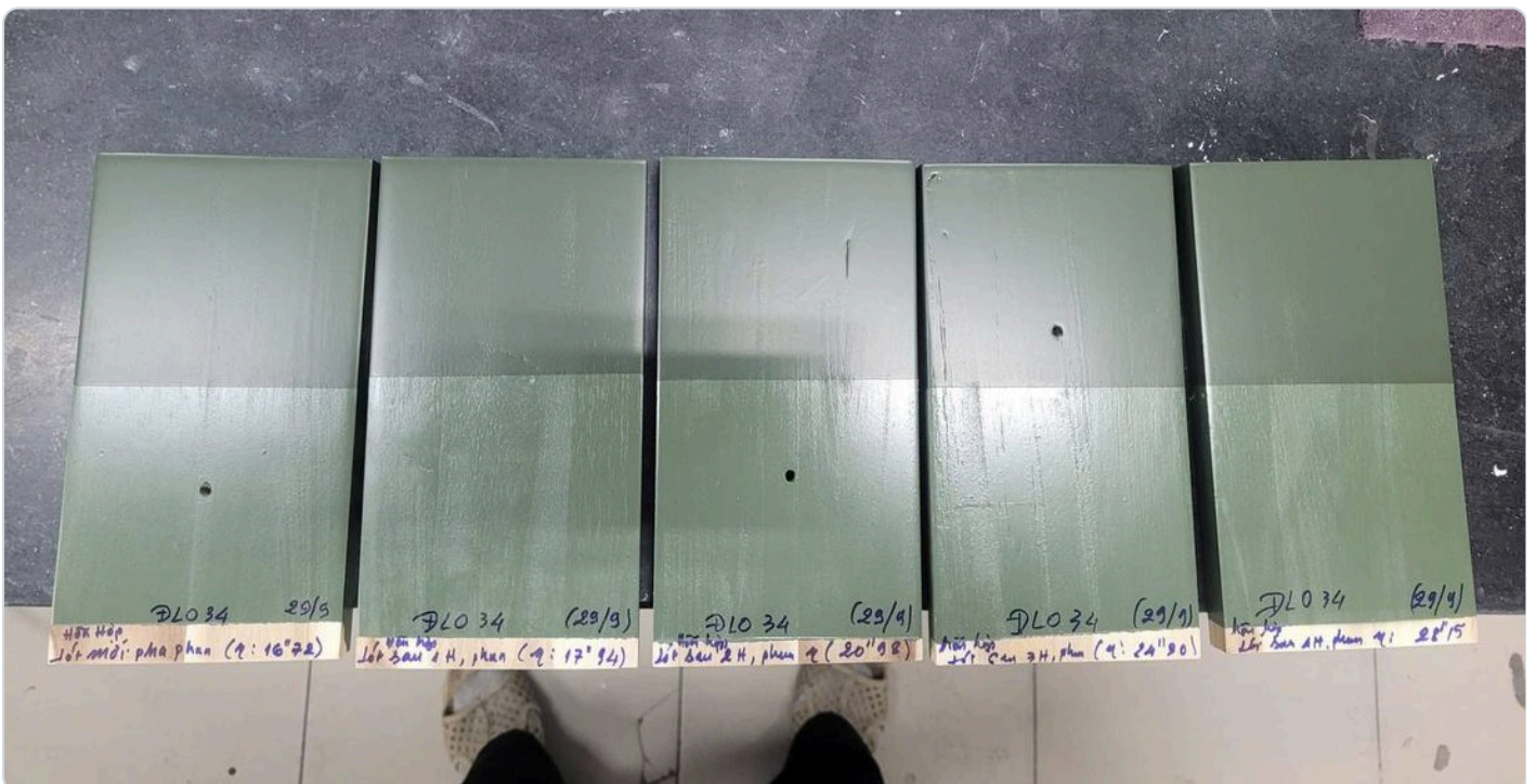
5 phôi gỗ trầm phun Lót màu ĐLO 34 theo 5 mốc thời gian sống của hỗn hợp (mới pha 16"72 → sau 4 giờ 28"15) — 29/09/2026.
