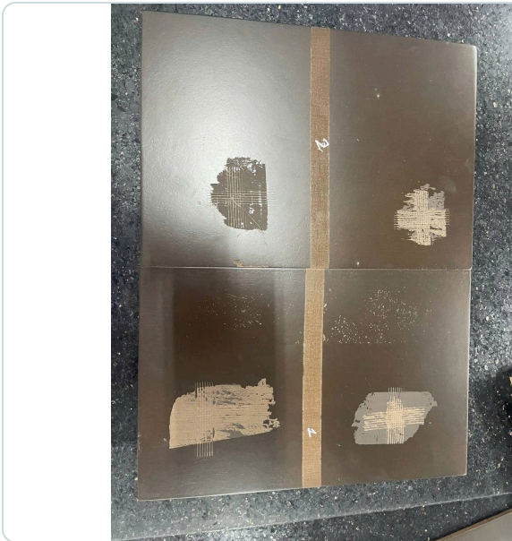
Ô cắt ca-rô thẻ mẫu màu DL 16/19 (Đặng Long): lớp glaze TRÓC LỚP — không đạt (05/10/2026).
