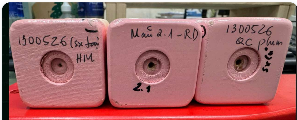
Hình 4: So sánh độ giòn/bề cạnh của 3 mẫu thử — (trái) SP sản xuất tại Hành Mỹ bằng máy tumbling với sơn hiện tại (MSSX 1300526); (giữa) SP sơn bằng mẫu sơn mới phát triển — phun tay (Mẫu 2.1 – RD); (phải) SP sơn bằng loại
