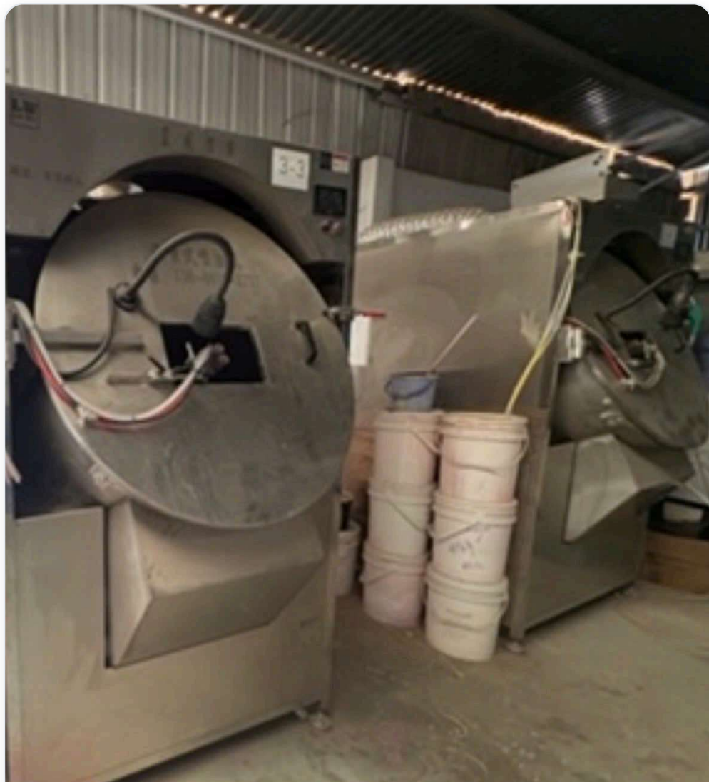
Hình 1: Máy Tumbling công nghiệp — lồng quay nghiêng, bảng điều khiển điện tử, kết nối chân không và hệ thống phun.
