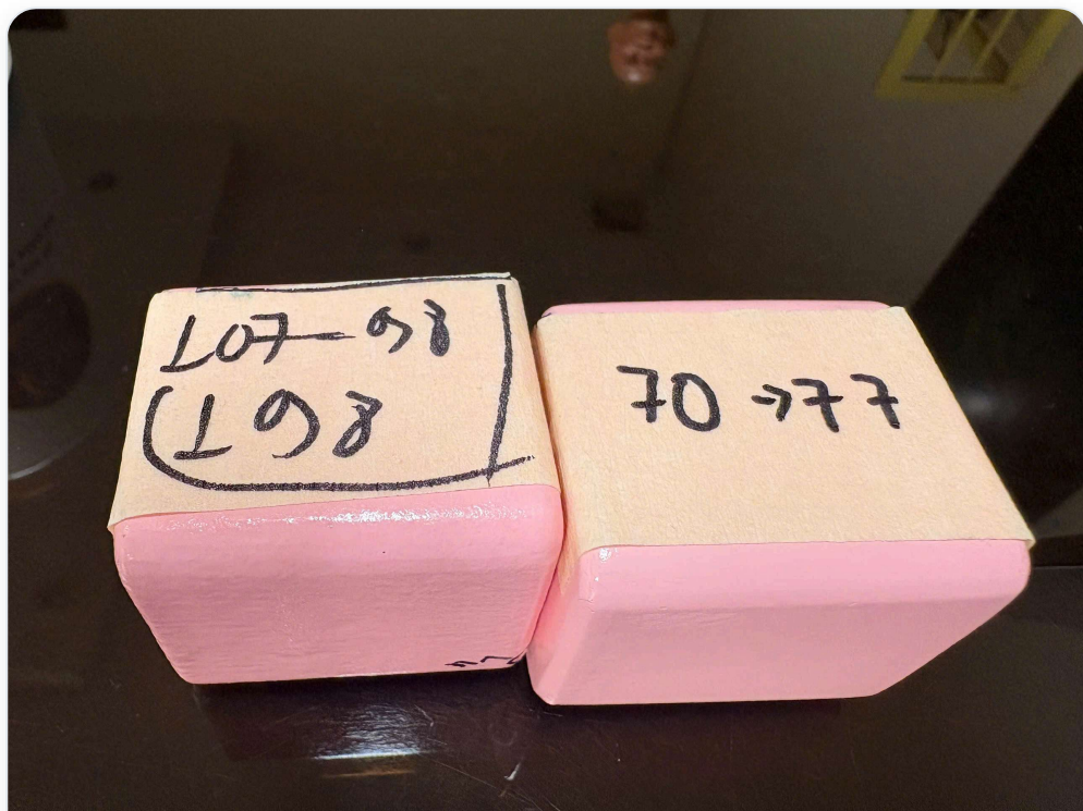
Hình 2: Khối trái Tumbling — bề mặt mờ, nhám, kết cấu thô, dễ bề cạnh (ghi chú L07-98/GT98); khối phải SPR (phun tay) — bề mặt láng, bóng, đẹp hơn (ghi chú độ dày 70→77 micron — đúng thông số màng SPR).
