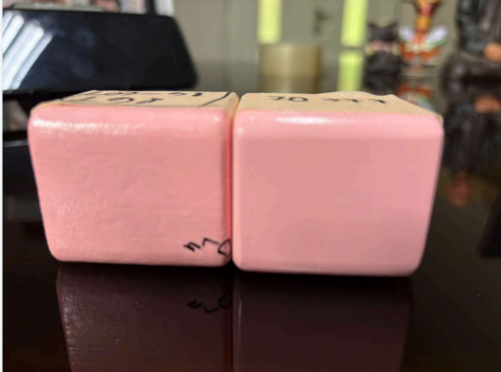
Hình 3: Cận cảnh bề mặt — Tumbling (trái) mờ, nhám, khuếch tán ánh sáng; SPR (phải) láng, bóng cao, phản chiếu rõ nét.
