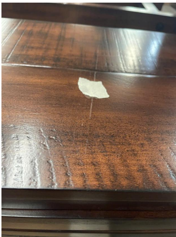
Hình 1: Bề mặt sản phẩm màu MP 394 (nâu sẫm bóng) — mảnh giấy carton dính chặt trên bề mặt sơn
