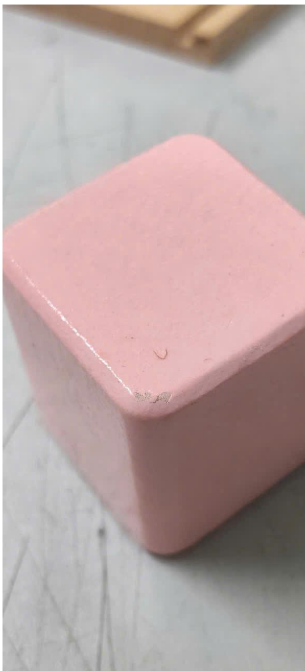
Hình 1: Khối sản phẩm màu hồng (HM S 0530R 20 BH BC) — vết tróc sơn rõ ở góc cạnh, lộ lớp nền bên dưới
