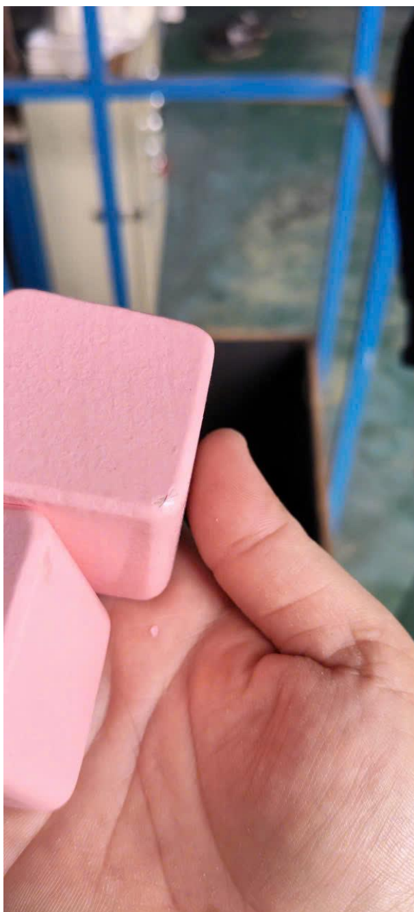
Hình 2: Sản phẩm bị tróc sơn cầm trên tay kèm mảnh sơn vỡ — minh chứng lỗi tróc tại góc cạnh
