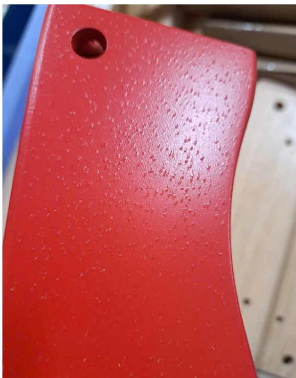
Hình 1: Bề mặt sản phẩm sơn màu đỏ (HM 05/24 H BC) nổi dày đặc các nốt ghim li ti — hiện tượng xì ghim gỗ
