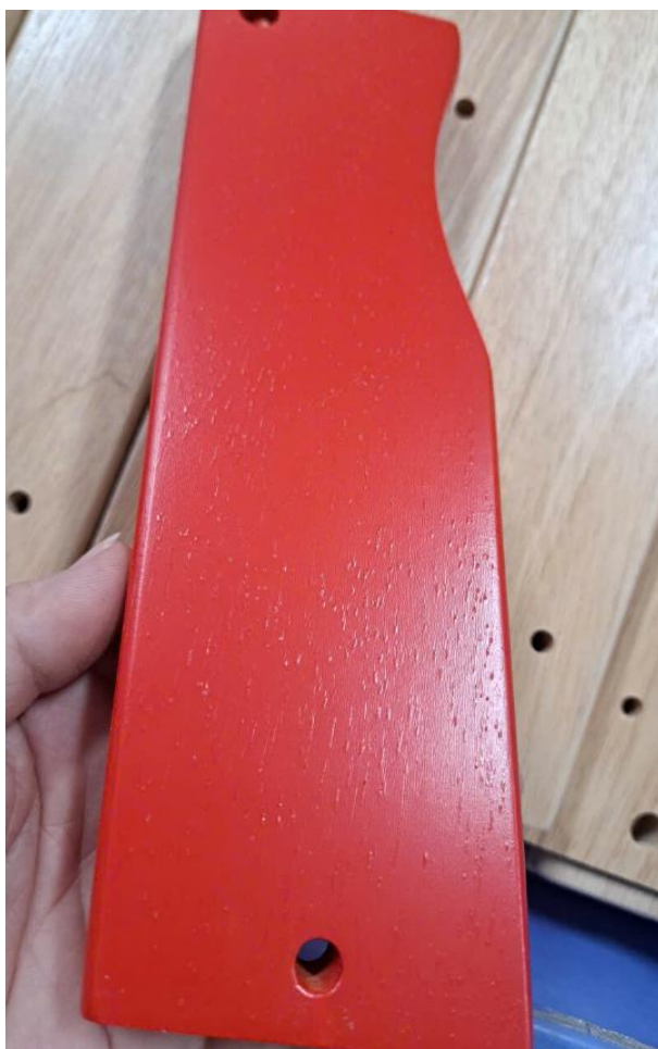
Hình 2: Chi tiết sản phẩm cầm trên tay — bề mặt sơn bị rỗ, nổi nốt sần (xù ghim gỗ) trên diện rộng
